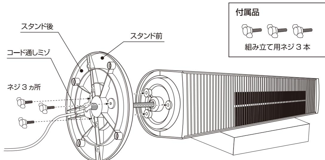
電源コードを図のようにスタンド底部の「コード通しミゾ」に確実に固定します。
