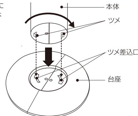
2)本体と台座がセットされましたら底面の1箇所を止めネジで確実に締めます。
