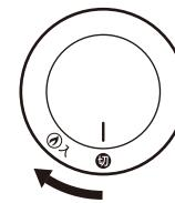
3.運転を止めたい時は、電源スイッチ(入)から(切)に回す。電源ランプは消灯します。
