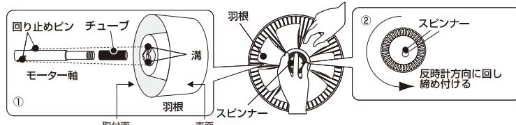
※チューブは錆止めで、取り付けの際は外して保管しておいてください。
