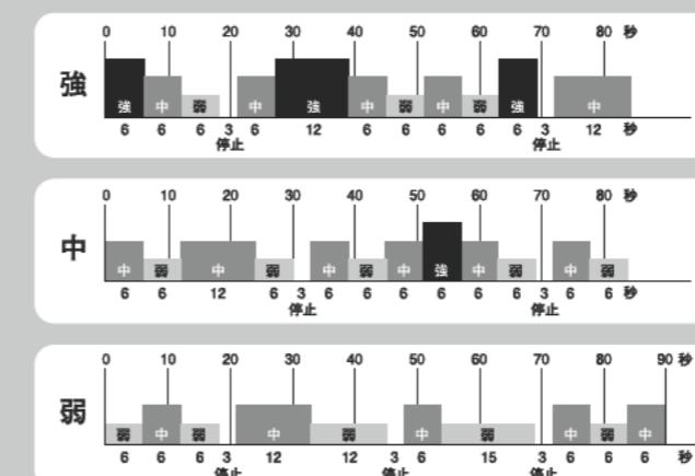
リズム風とは左図の間隔で強、中、弱を繰り返し、自然に近い風をお届けします。操作パネルは弱・中・強のランプが点滅します。
