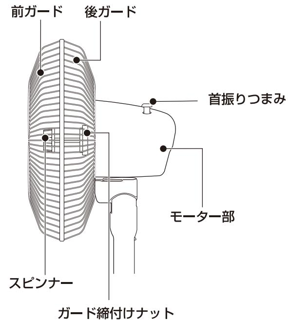
扇風機は分解して梱包してありますので、次の説明に従って正しく組み立ててください。梱包部品は、この扇風機を収納するときに必要ですので梱包箱と共に保管してください。
