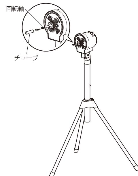
**5 後カバーをはめ込み、締め付けナットで締める**
