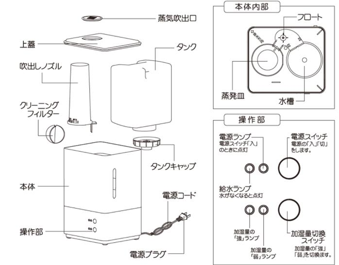
各部の名称: 本体内部、上蓋、吹出しノズル、クリーニングフィルター、タンク、蒸発皿、水槽、タンクキャップ、電源コード、電源プラグ、操作部、電源ランプ、電源スイッチ、給水ランプ、加湿量の「強」ランプ、加湿量の「弱」ランプ、加湿量切替スイッチ。
