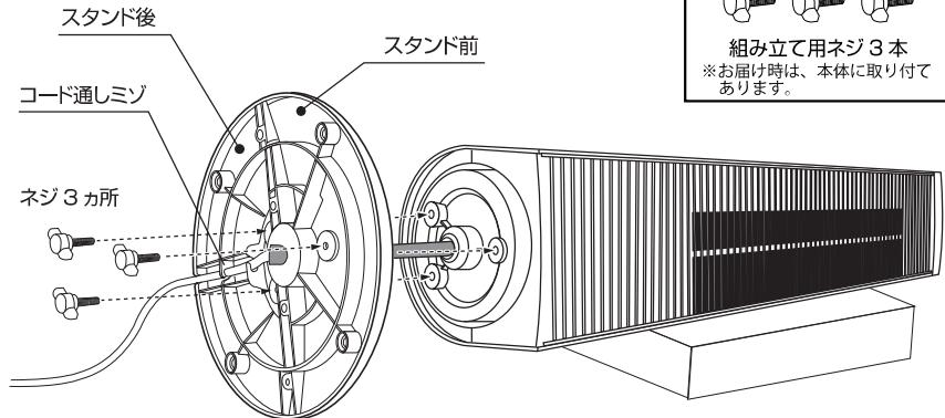
電源コードを図のようにスタンド底部の「コード通しミゾ」に確実に固定します。
