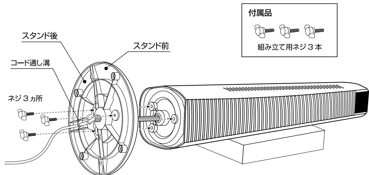
電源コードを図のようにスタンド底部の「コード通し溝」に確実に固定します。
