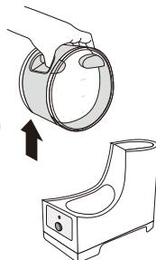
3 水タンクキャップをしっかりと締め本体に水タンクを取り付ける。
