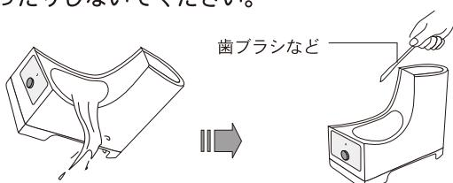
※本体蒸気吹出し口内の蒸発皿(水を沸騰させる部分)に水分中に含まれるカルキ等の不純物がご使用に伴い堆積していきます。
