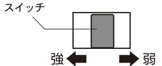
■羽根の回転を停止させるには、スイッチを中央にスライドさせるとすべての運転が停止します。
